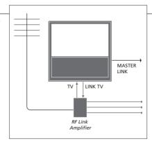
وصل كابل Master Link بالقبس المتاح المسمى . . . . MASTER LINK بالتليفزيون. لتوريع إشارات الصورة إلى غرف الوصلات، وصل كابل هوائي عادى بالمقبس المسمى LINK TV بلوحة التوصيل الرئيسية. ثم مد كابل الهوائي إلى RF Link Amplifier وكابل Master Link إلى غرفة الوصلة. اتبع التعليمات المرفقة بجهاز غرفة الوصلة.
